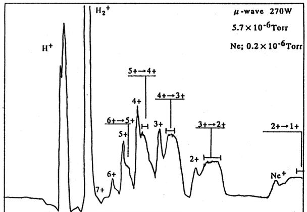
Fig.4. <sup>20</sup>Ne ions spectrum
