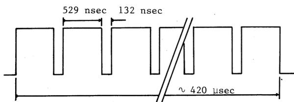
Fig. 2 H<sup>-</sup> Injection Beam
