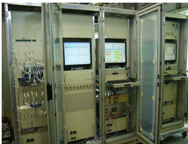
図 7：改良した LLRF システム（左 3 ラック）と真空統括制御システム（右 1 ラック）
