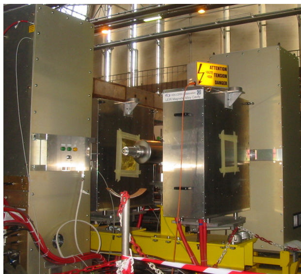
図1、CERN-LEIRに設置された2台の空洞と増幅器
