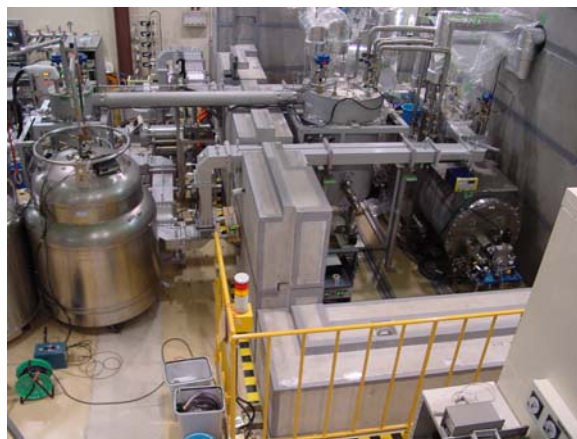
図1：クライオモジュールの大電力試験用設備
