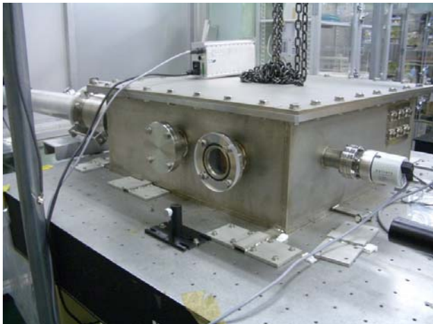
図 6 : 加速器室側集光チェンバー（上）と 実験室側取出しチェンバー（下）の写真
