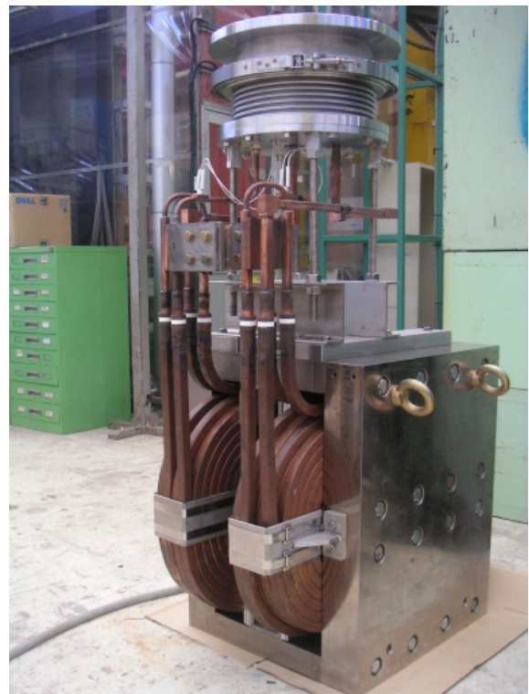
図 2: 真空運転試験用電磁石の写真。
