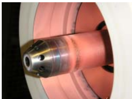
図2．引出電極と絶縁セラミック
