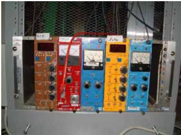
図4：ストリーク管用の各種高圧電源
