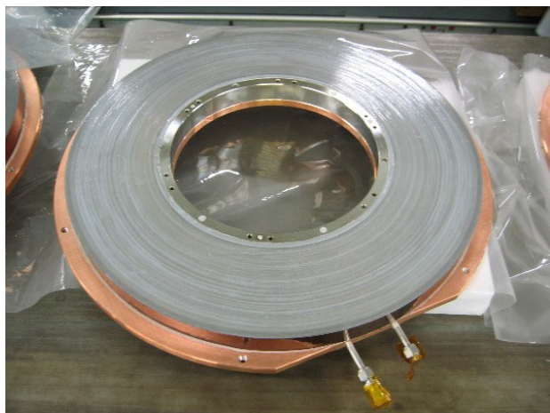
図4 冷却銅板を接着したコア
