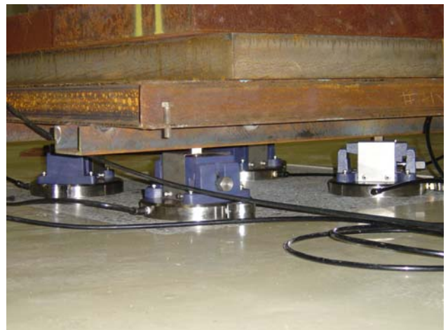
図6：研削した床面上で浮上したレベリングブロック付きエアーパッド
