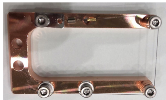
Figure 1: ワイヤーターゲットの形状。
