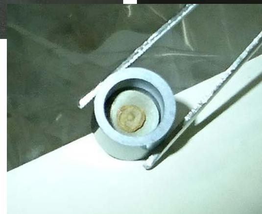
照射後の様子 (15 MeV protons, 3  $\mu$ A x 3 h)
