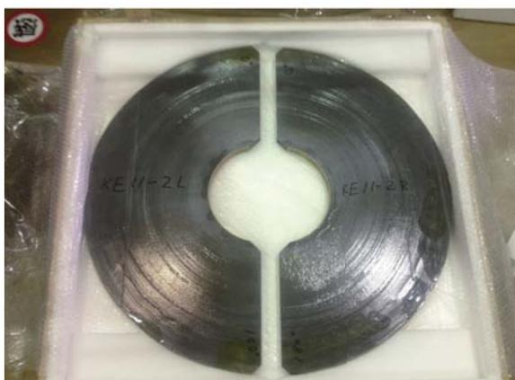
図 21 最初の FT3L 大型カットコア. ダイヤモンド研
