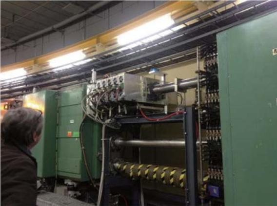
図 25 CERN PSB (PS ブースター) に設置された金属磁性体空洞. PSB は 4 階建の加速器であり, 4 台の加速器が同時にビームを加速し, ほぼ同時に PS に向けビームを取り出す. その一番上のリングに金属磁性体空洞は設置されている. 空洞の横に直結しているのが半導体アンプである.
