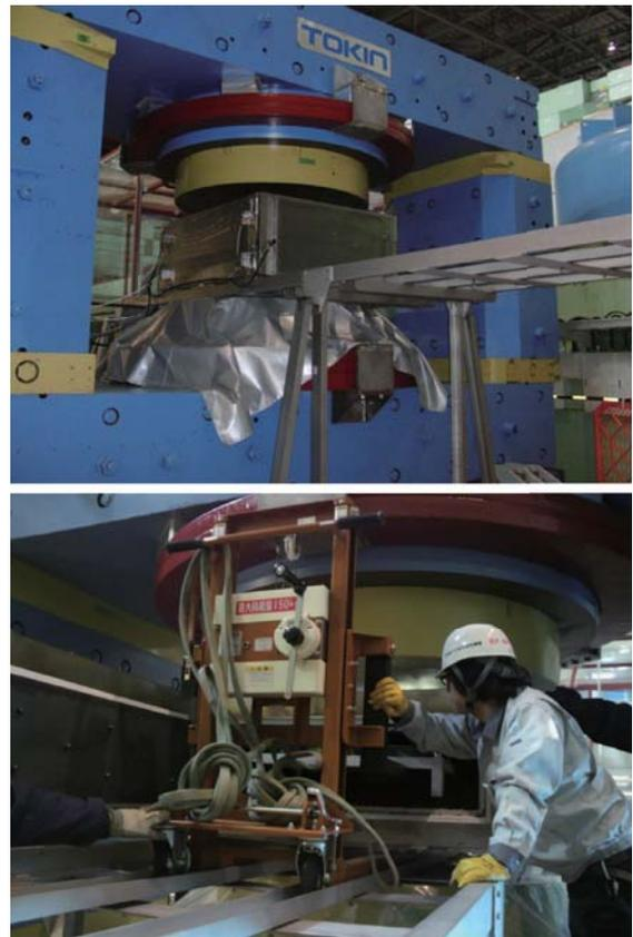
図 18 FM 電磁石とオープン。上：オープンの架台を地震の直前に補強したため、オープンには致命的な損傷はなかった。下：オープンへの磁性体コア設置風景。
