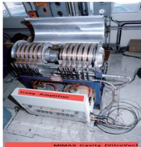
図5 世界最初の金属磁性体空洞. VITROVAC® (アモルファス) を用いた空洞である。
