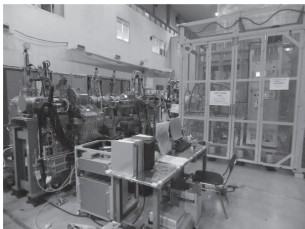
図 13 イオン源の工場でのビーム試験.
