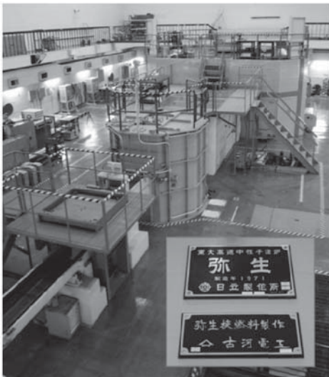
図18 高速中性子源炉弥生(平成23年3月11日をもって安定停止、廃炉措置進行中、加速器中性子源を挿入して再利用計画中)
