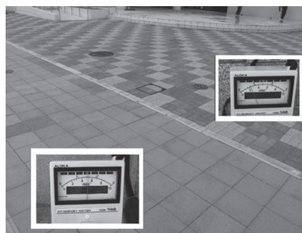
図4 隣接したタイルでの計数率の違い GM管測定器のレンジは3 kcpm。左側のタイルで1.5 kcpm、右側が0.75 kcpm。測定は地上高約10 cm。
