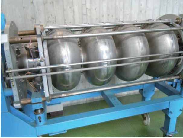
図3 LEPに用いられた352MHzの4連空洞のプロトタイプ。回転式温度マッピング装置が取り付けられている
