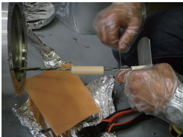
写真2 Ti-Zr-Vのツイストカソード。各ワイヤは直径3mmだが、ビームダクトによっては直径1mmのものも使う。
