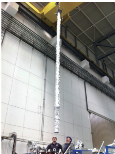
写真7 クレーンで移動中のコーティング用ダクト。
