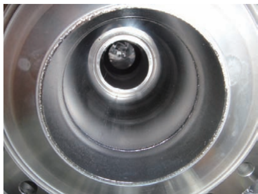
写真3 NEGコーティングされた銅製ビームダクト。
