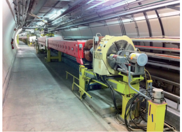
写真6 SPS トンネル内の写真。赤い偏向電磁石内ビームダクトへのカーボンコーティングを目指す。
