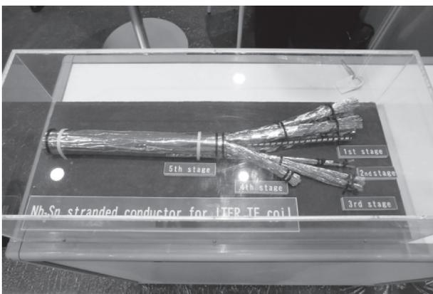
図 6 ITER-TF コイル用ストランド線 (日立電線の展示ブースにて)
