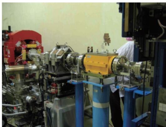
図 15 PF リングのアンジュレータ 2 番の長直線部下流に設置したパルス 6 極 (黄色).
