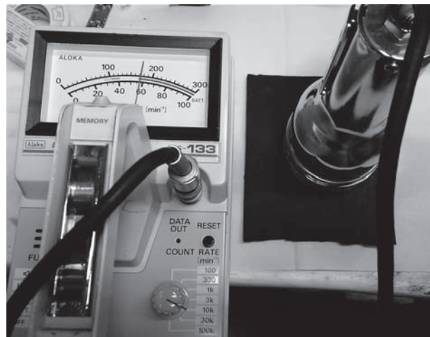
図6 軽トラの高線量樹脂製カバー (約6 kcpm)
