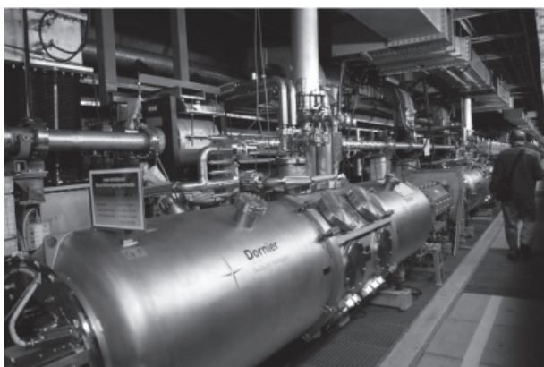
図 3 HERA 加速器にある超電導加速空洞
