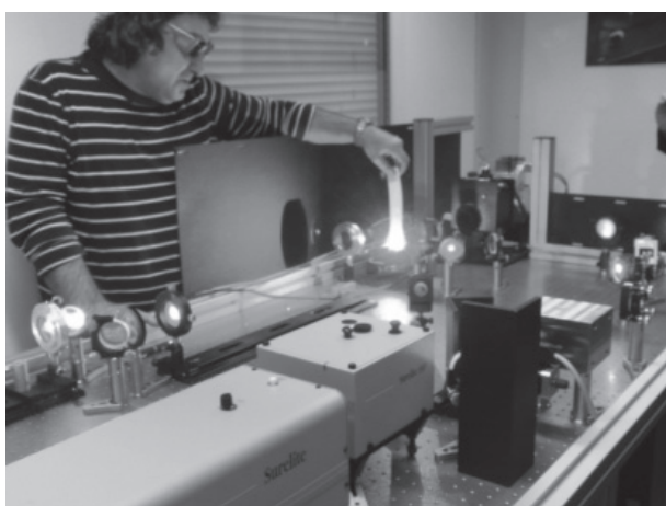
図5 レーザーワイヤスキャナのテストベンチで説明している DESY のスタッフ
