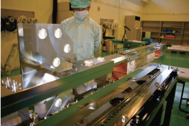
図5 SCRIT 装置内部構造の組立写真. SCRIT 電極, スクレーパー, インフレクタ, および BPM が約 2 m の共通架台にアライメント設置され, その架台が 2 軸に微調できる仕組みとした
