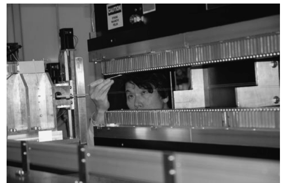
図5 シムによる磁場調整を行う筆者
