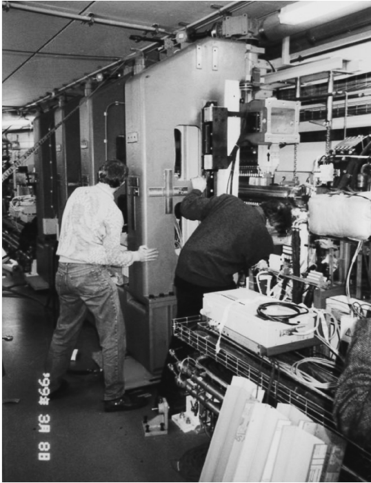
図1 APPLE アンジュレーターの設定の様子
