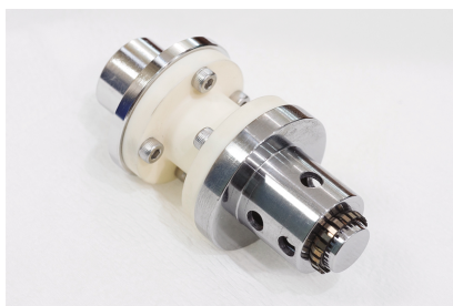
図 2 KEK-STF 実験用に構築中の RF 電子銃に用いるカソードプラグの写真。写真右下の面がカソード面で、その周りに王冠のように取り巻いているインコネル 750 製のコンタクトフィンガーが見える。セシウムテルライド薄膜作製後に量子効率測定を行うため、電気的に浮いていなければならず、アルミナの碍子を用いて先端部は浮かされている。先端部付近にヒーターを内蔵するため、エア抜き穴が多数ある。文献 19) より転載。
