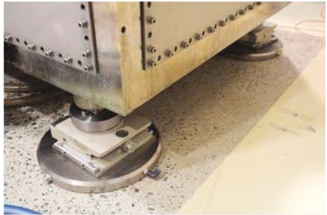
図5 (左) ゆかとけんさく(床研削装置)と(右) 研削したコンクリート面とエアーパーッド
