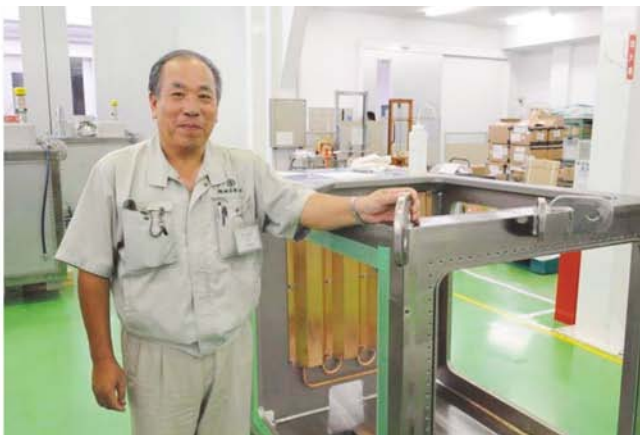
図8 モノコック構造のタンクは、鉄板窓枠フレームを溶接して製造。床面には部品を取り付けるためのタップ孔を加工。右はニッケルメッキ終了後のタンク。写真は城南製作所の松村氏。担当メーカーの方々、大変にご苦勞さまでした
