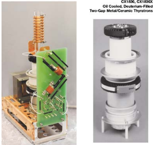
図11 サイラトロン E2V CX1836 の実装. 交換時にはユニットで取り外し可能. トランスはヒータトリザーバ用でありノイズ遮断用の絶縁トランスともなっている. 右は E2V 社カタログより転載
