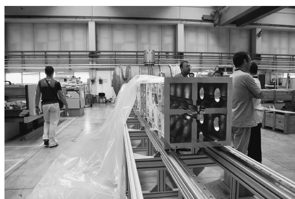
写真 5 INFN-LNL で開発中の RFQ モデル空洞
