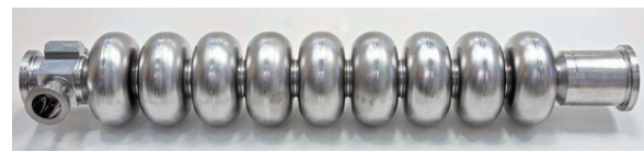
図 A@ 主加速器用超伝導空洞 (9セル) の試作機
