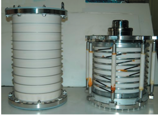
図 R フォトカソード電子銃用に新しく製作した 500 kV 用セラミック管 (左) と JAEA FEL で使用した 250 kV 用セラミック管 (右). いずれも高電圧を安定に印加するために多段分割式の構造としている.
