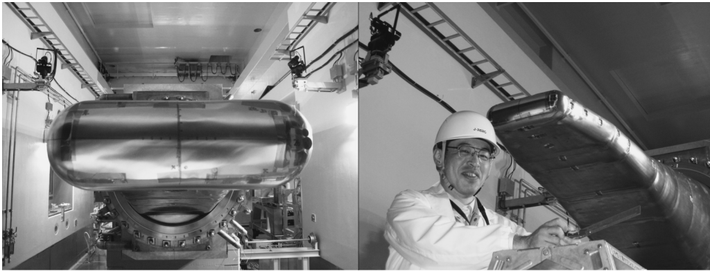
図11 ターゲット先端部とプロフィール測定用に先端部に貼り付けたアルミフォイル（厚さ 0.3 mm）
