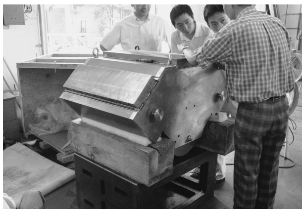
図3 RCS用Q磁石の試作機（4分の1部分、積層鋼板）を前に意見交換を行っている様子
