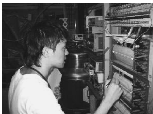
図 6 RRR 測定の様子。超伝導転移を観察している
