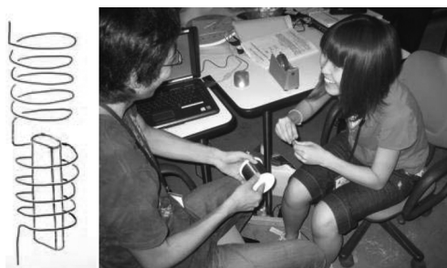
図8 超伝導磁化測定用コイルとコイル巻き．上下のコイル線の巻き方向が互いに逆になっている以外は、同じである．上部の空芯コイルによりサンプルとコイルの隙間の効果をキャンセルして真の磁化が測定できる
