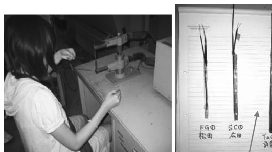
図 5 ポイント溶接器で RRR 測定サンプルに銅線を溶着している様子
