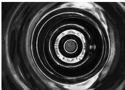
図5 クラブ空洞内部の様子 奥の中心に見えるのが同軸ビームパイプの先端部で、右から突き出ているのが入力結合器の先端部である。
