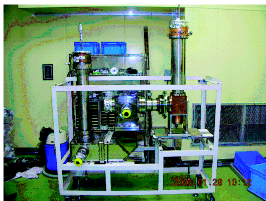
図11 入力結合器の単体試験用テストベンチ 右側のT-stub構造を持つのがクラブ用で左側の直管タイプが加速空洞用である。間は導波管で連結されている。テストベンチでは2台同時にコンディショニングが行えるようになっている。
