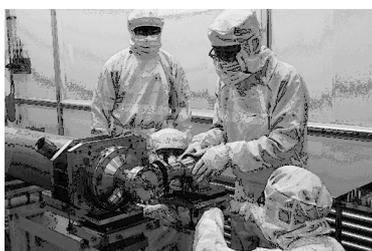
図9 クリーンルーム内での入力結合器の取付け
