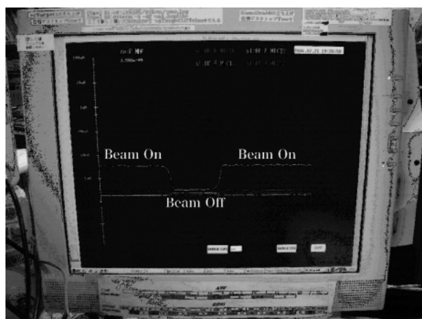
図4 fRCにおいて初めてウランビーム加速に成功した時の様子(06/07/21)。ラディアルプローブを設計最外周軌道においてビーム量を測定した。3.6 nAのビームが観測されている。
