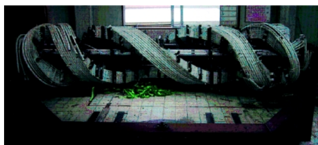
図 20 巻線完了時のヘリカルコイル
