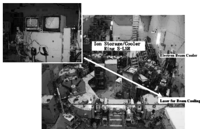
図10 S-LSRと電子ビーム冷却装置及びレーザー冷却部とレーザー冷却の調整の様子
