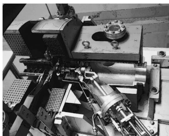
図11 KEKB 入射器陽電子源のカット模型。標的は、リニア駆動機構により、陽電子入射時に挿入される。4 GeV 電子は、右側から入射し、標的で電子・陽電子対が生成される。
