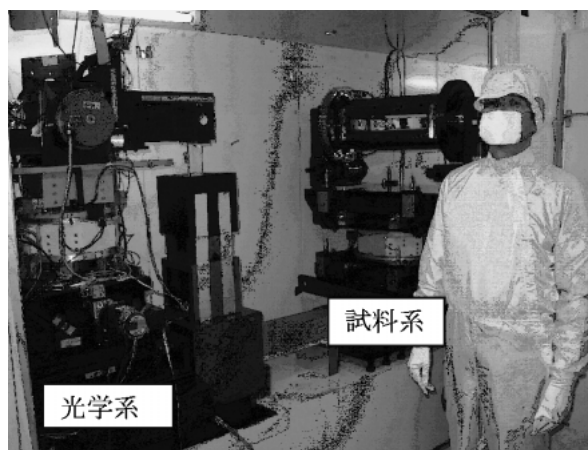
図9 設計製作した傾斜角積分型形状計測装置 光学系：直交する2軸の回転テーブルとXYXテーブルで構成。回転テーブルの直交点からレーザー光を射出し、反射光が直交点を通るよう試料系の回転テーブルと合わせて調整する。 試料系：直交する2軸の回転テーブルとXYXテーブルで構成され、ミラー取り付け治具を含む。
