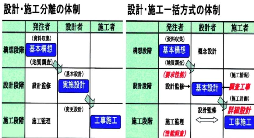
図8 設計・施工分離と、一括方式の比較
