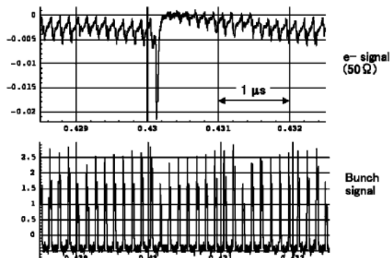
図7 電子雲モニター出力波形とバンチ信号. HV パルス電圧を印加した場合.
