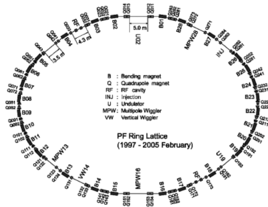
図2 高輝度化改造（1997年）後のPFリングのラティス。
