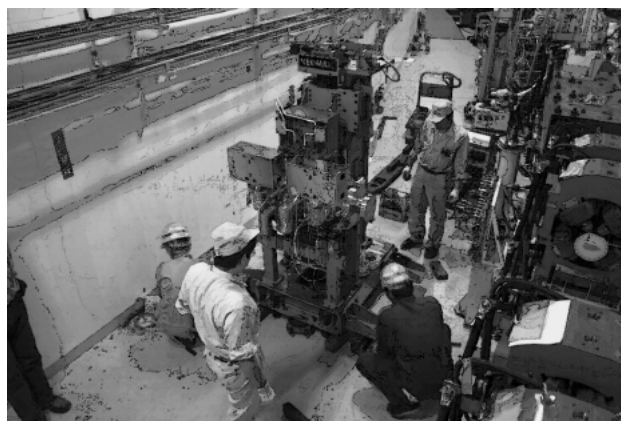
図9 搬入作業中の短周期アンジュレータ#17，写真右側にみえる2組のダブルレット四極電磁石の間隙に設置される。アンジュレータ真空容器のビーム方向の全長は約1 m，真空中に納められた磁石列は周期長が16 mm，全長約500 mmである。
