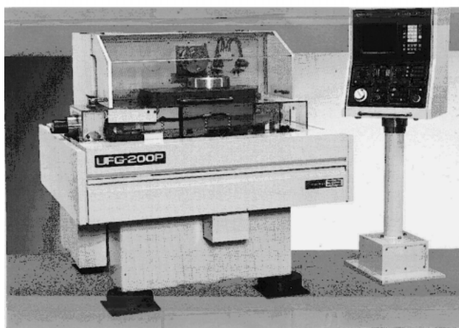
図16 ポリゴンミラ加工機とポリゴンミラ 2)
