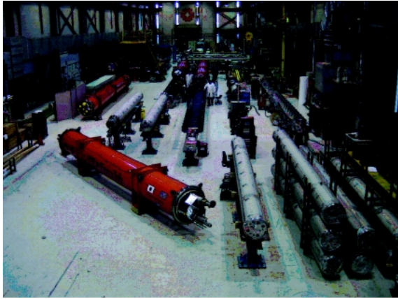
図7 四極磁石のクライオスタットへの組込み (@Fermilab). KEK から送られ、組込みを待つ磁石本体 (手前右). 磁石組み込みを完了したクライオスタット (左). 組込み作業中 (中央奥).
