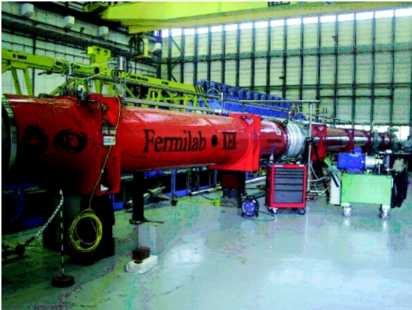
図8 インナートリプレット (Q1-Q2a-Q2b-Q3) の総合組合わせ試験 (@CERN).
