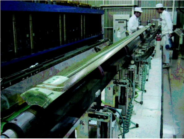
図4 超伝導磁石コイル巻き線 (@東芝).
