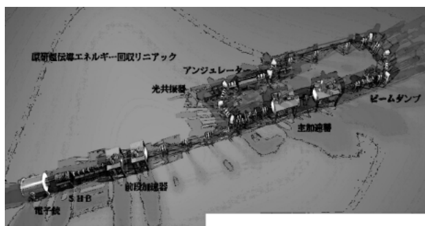
図5 エネルギー回収型超伝導 FEL
