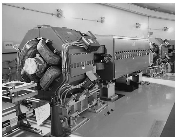
図2 3 GeV シンクロトロンに配置されたポリイミド樹脂コイルを使用した電磁石群（日立製作所殿製）。
