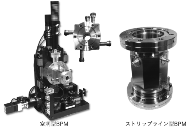
図9 空洞型BPM(左)とストリップライン型BPM(右).
