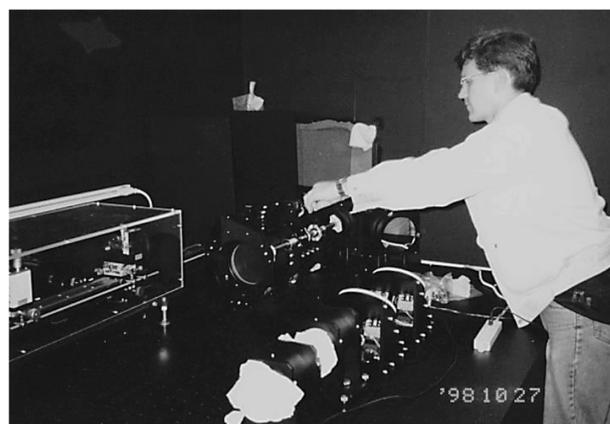
写真1 自ら設計をした150 mm 径の転送レンズを検査する Flanagan さん。
