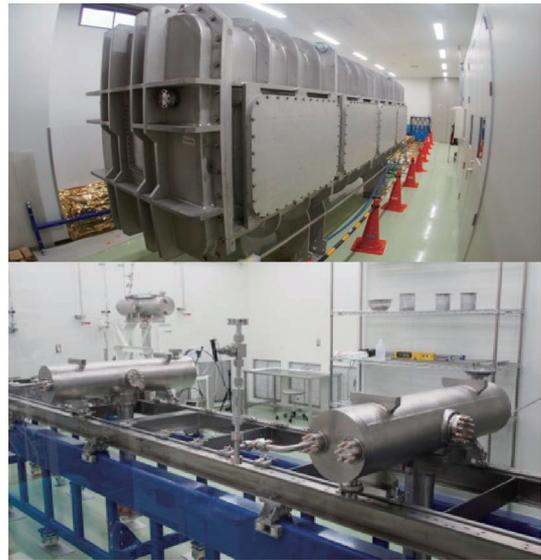
図15 (上)超伝導線形加速器の真空容器、(下)超伝導空洞共振器。
