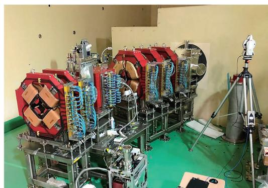
図20 高エネルギービーム輸送系 (HEBT) の写真.
