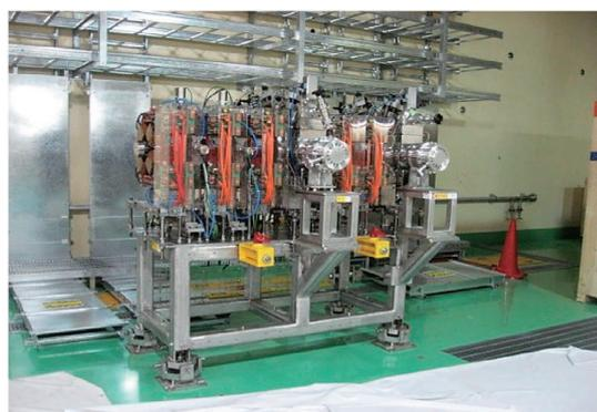
図17 中間エネルギー輸送系 (MEBT) の写真.
