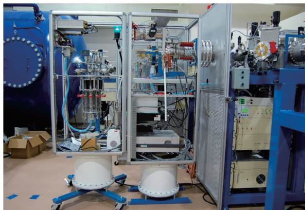
図7 CO 2 Gas Type MC-SNICSの写真。左側のゲージがCO 2 ガス試料の供給システムとなっている
