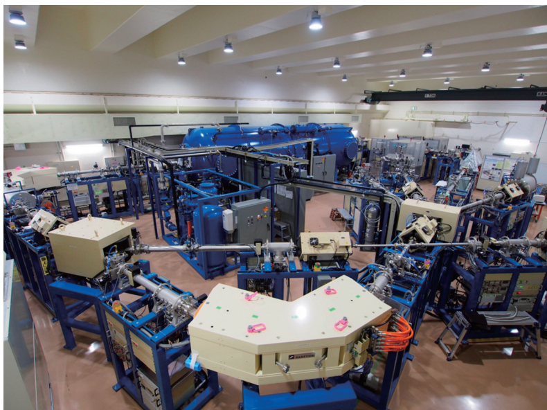
図2 6 MV タンデム型静電加速器を設置した加速器室の全景写真
